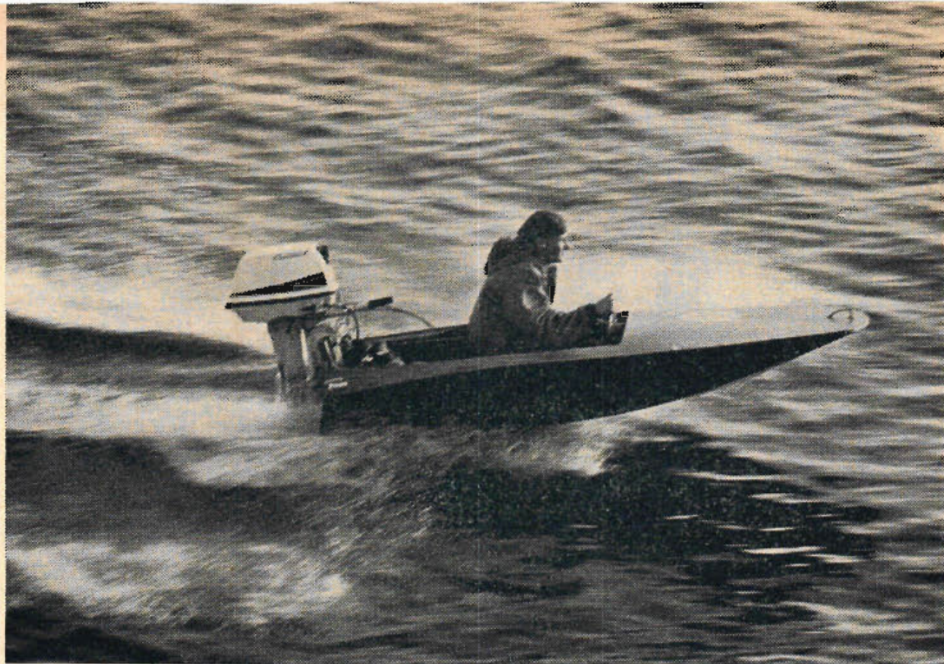
Speedy rusar fram över vattnet med skummet yrande om bogen. Farten är 27 knop och motorn är en Crescent Marin på 18 hästkrafter.
