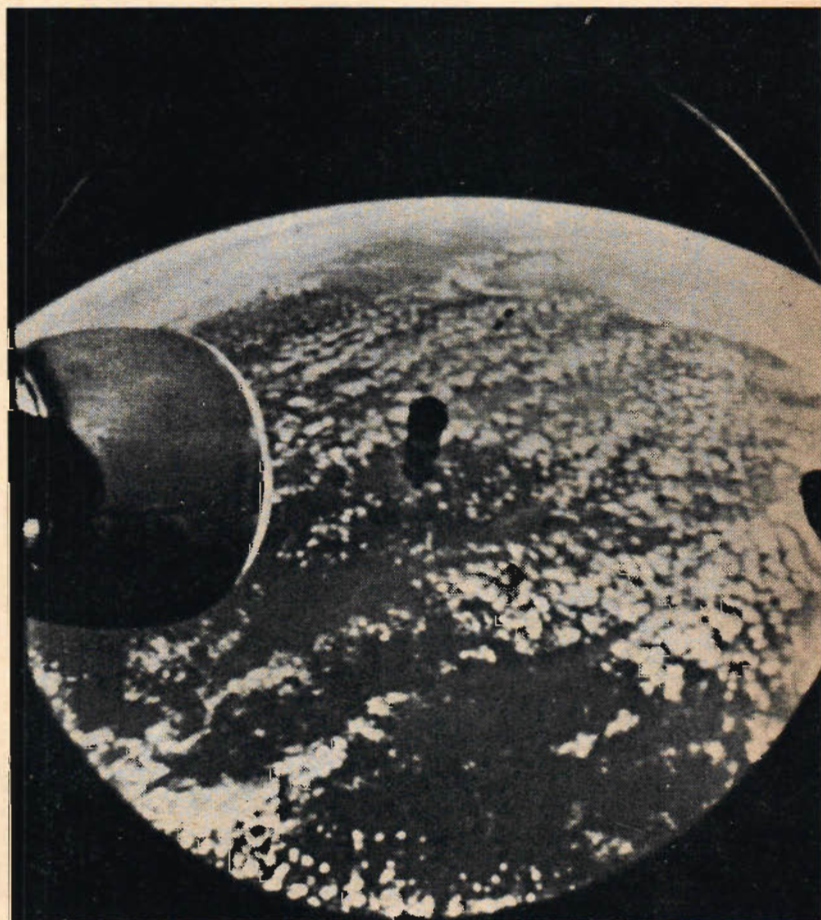
6 Hur kunde bilderna tas från den obemannade raketen? En kamera inregistrerade automatiskt händelseförloppet och sköts sedan ut från det sista raketsteget. Kamerabehållaren var försedd med fallskärm och bärgades.
