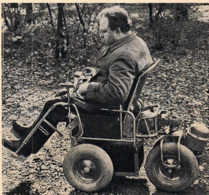
En ny stol för handikappade har konstruerats av provinställaren i Kälarne, dr Per Uddén. Stolen drivs elektriskt med batterier och alla manövrerorganen finns placerade på en panel som är så placerad att en handikappad lätt kan sköta desamma. På bilden demonstrerar dr Uddén stolen som kostar cirka 7 000 kr.
