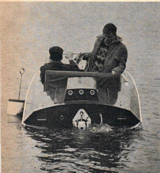
Aggregatet är litet och nätt och stör inte på något sätt båtens linjer. Motorhuvud är avtagbar och motorn är därför lätt åtkomlig för service o. d.
