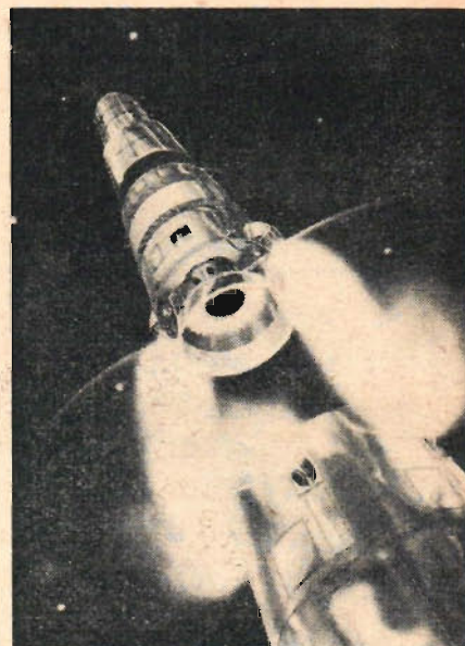
Teckningen visar OPHOS 1E som toppsteg till den amerikanska Thor-farkosten. OPHOS har just lämnat bärraketten och strax dessförinnan har höljet kring nosen sprängts bort.
