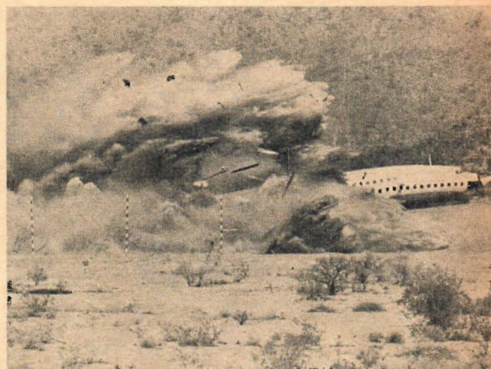
I Amerika håller man som bäst på att försöka utröna vad som kan göras för flygpasagerarnas säkerhet. Man låter det ena planet efter det andra krascha. Med hjälp av bandspelare och filmkameror registreras resultaten. Dockor "tjänstgör" som besättning och passagerare. Här ovan är det en Super Constellation som kraschar. Detta var det andra försöket i den serie som leds av U S Federal Aviation Agency.
