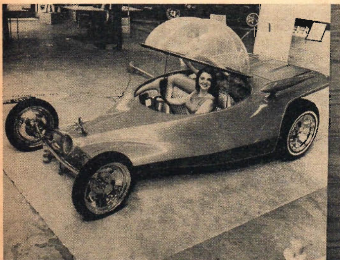
"Morgondagens bil", kallad "Road agent" ses här på bilden ovan. En Corvair-motor på 250 hk finns på plats i aktern. Hög- och sänkbar "ostkupa" skyddar föraren att blåsa bort. Nämnas kan att föraren har TV bredvid sig. Men det finns ett verkligt problem — att komma i och ur bilen, i synnerhet om det är en dam med snäv kjol.
