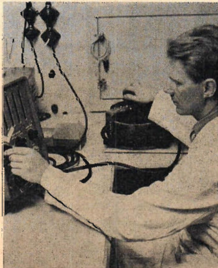
Elmotorns (och laddningens) varvtal regleras med en vridtransformator. Det räknande instrumentet t v ger uppgift om varvtal. När det önskade uppnåtts ges besked därom...
