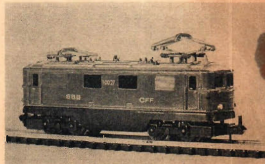
Det schweiziska snälltågsloket Re 4/4 ingår i Arnold-sortimentet. Kopplingen är liksom på alla N-lok och vagnar helautomatisk. Loket kostar 55:50. Karossen är utförd i metallgjutgods.
