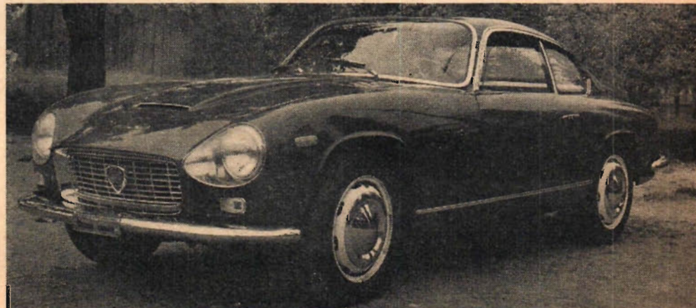
Lancias framhjulsdrevna Fulvia finns nu i en ny och sportigare modell, Fulvia 2 C med mjukare form och hårdare trimmad motor. Effekten är 71 hk vid 6 000 v/min och toppfarten ligger på 145 km/tim. Stående kilometern avverkas på 37 sek. Bättre bromsar och ett mera tillförlitligt elsystem är andra nyheter.
