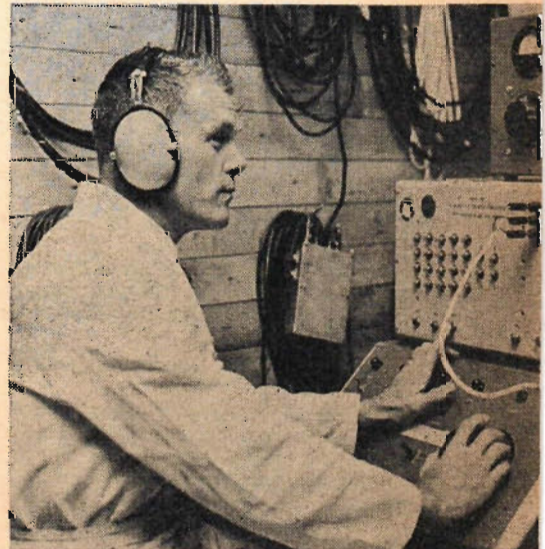
...till den som sitter vid manöverpanelen och utlöser sprängladdningen när också kamerans roterande spegel uppnått det föreskrivna varvtalet. Och några mikrosekunder senare öppnas slutaren.
