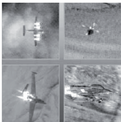
Figur 37. Målsökaren i den Israeliska jaktroboten Python 5 har en stirrande IR-sensor med 128 x 128 upplösning. I kombination med effektiv bildbehandling är denna generation av robotar mycket svåra att störa med konventionella metoder såsom exempelvis facklor. (Källa: Rafael Industries)
