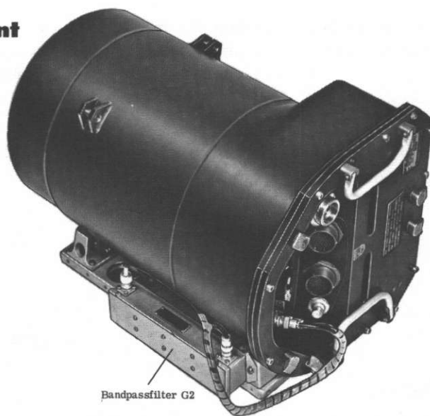
Bild 15. Apparatenheten med huv på monteringsbädden (flygplan 35A)
