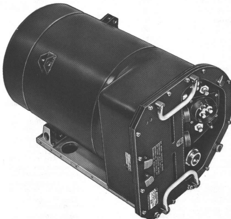
Bild 1 b. Apparatenheten (med huv) till Radar M3333-059501 (PN-595/A) fastspänd på monteringsbädden (fpl 35C)
