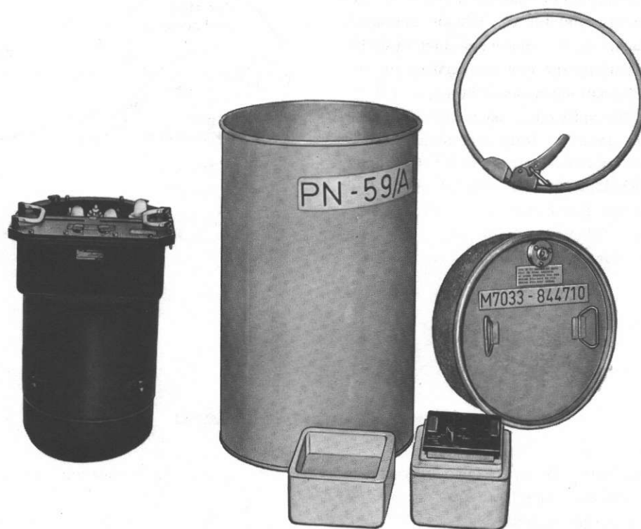
Bild 6. Apparatenheten och manöverlådan till Radar PN-595/A med tillhörande emballage för interna transporter
