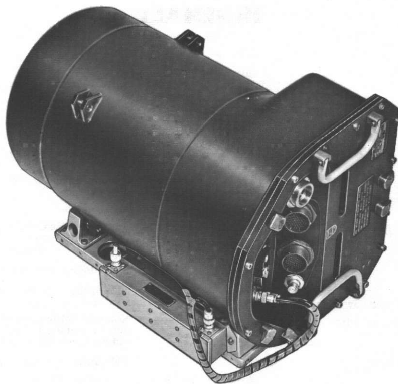
Bild 1 a. Apparatenheten (med huv) till Radar M3333-059501 (PN-595/A) fastspänd på monteringsbädden (fpl 35A)
