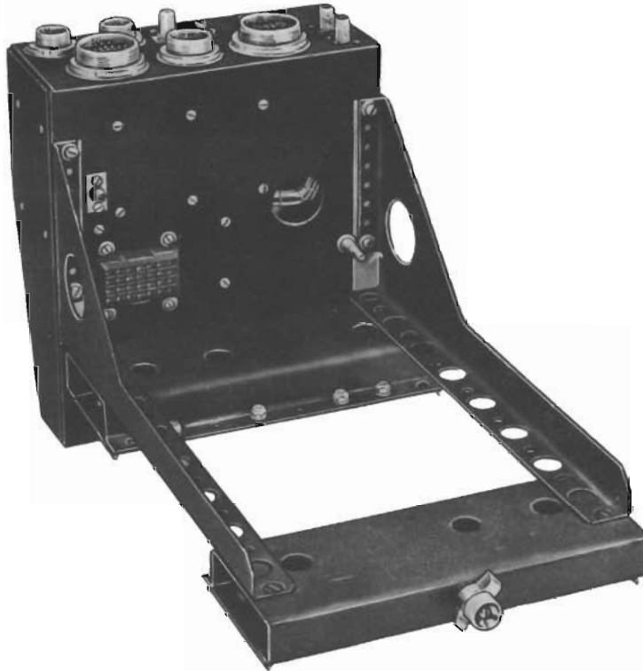
Bild 24. Monteringsbädd med kopplingslåda RP 016.84 för SM-enhet
