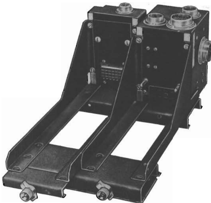
Bild 25. Monteringsbädd med kopplingslåda RP 016.83 för TB- och Stab-enhet
