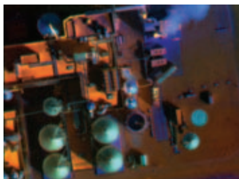
Figur 24. Flygregistrering över industriområde i Norrköping. Vänstra bilden visar en visuell registrering och den högra bilden (kombination av band) motsvarande multispektrala registrering i 1,5-5 \mu\text{m} . Liksom i VIS erhålls i SWIR god information om ytstrukturer och föremåls form. I TIR fås information om objektens temperatur. Lägg märke till ledningen i närheten av lastbilen – något varmt verkar ha fyllts på eller avtappats. Det kan också noteras att VIS ger information som inte finns i den högra bilden.
