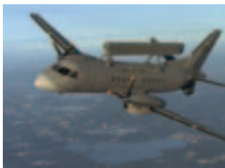
Figur 45. Svenskt spaningsflygplan med radarn Erieye. (Bild: Försvarets Bildbyrå / Johnny Lindahl / SAAB).
