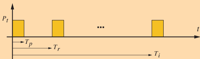
Figur F13. Exempel på pulsvågform där varje puls måste moduleras med lämpligt fasskift (ej illustrerat) för bibehållen räckvidd och högre upplösning än pulsen annars medger.
