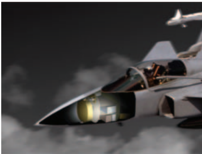
Figur 53. Multifunktionsantennen till nosradarn i ett stridsflygplan ser ut som ett fasettöga med sina mer än tusen antennnelement på den plana fronten. Här i en möjlig framtida JAS 39-användning. (Bild: Ericsson Microwave Systems AB).
