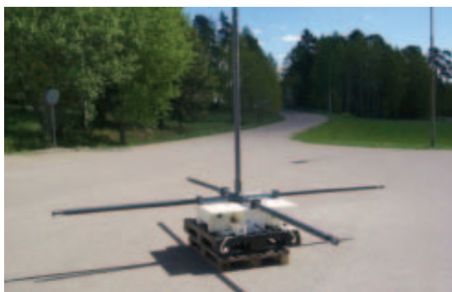
Figur 13. Multisensorplattform för havsbottenbruk utvecklad på FOI. Plattformen är bestyckad med ett treaxligt elektrodsystem av kortbasty för mätning av elektriska fält, magnetometer, trycksensor, hydrofon, lutningsgivare, kompass samt dator eller insamlingsenhet med mät- och kommunikationskort. Systemet är 4 m över de horisontella elektrodarmspetsarna.
