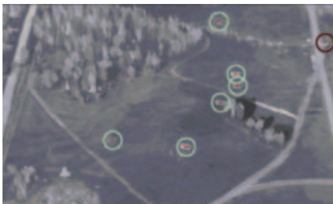
Figur 26. Exempel på detektion av utbredda markmål i simulerad termisk IR-bild. Sex mål detekteras korrekt och ett falsklarm genereras.
