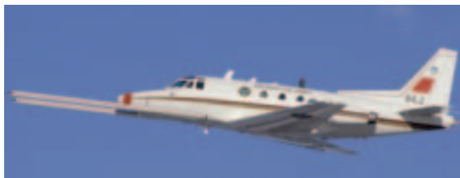
Figur 50. FMVs provflygplan TP86 Sabreliner med CARABAS-II VHF-bands SAR installerad ombord under en flygvapenövning år 2000. Varje cylinder innehåller ett bredbandigt antennelement. Elementens utformning och placering är gjord för att minimera den elektromagnetiska kopplingen med den metalliska flygplanskroppen och samtidigt minimera inverkan på flygplanets aerodynamiska egenskaper. (Bild: Försvarets Bildbyrå/Peter Liander).
