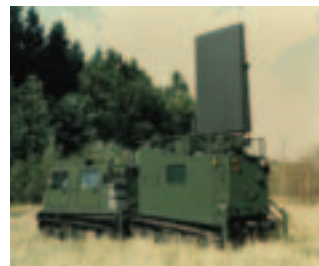
Figur 46. Svensk artillerilokaliseringsradar ARTHUR (ARTillery HUnting Radar). (Bild: Försvarets Bildbyrå / Lasse Sjögren).
