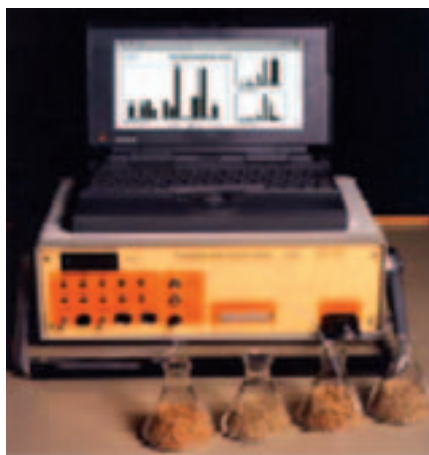
Figur 18. En elektronisk näsa består av ett antal kemiska sensorer, en datainsamlingsenhet samt en dator.
