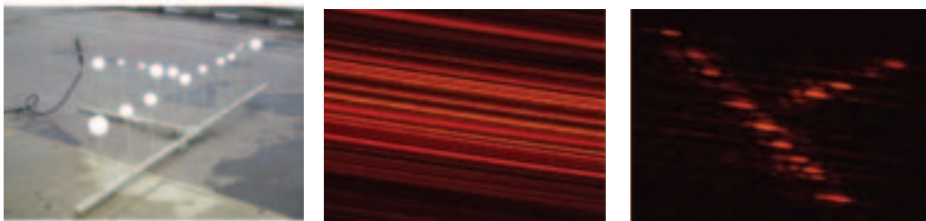
Figur 8. Illustration av möjligheter med syntetisk apertursonar. Till vänster ett foto på 'målet'. I mitten en bild av målet som det ses av en traditionell aktiv sonar. Till höger har samma sonardata analyserats med syntetisk apertur och detaljerna i målet framträder.
