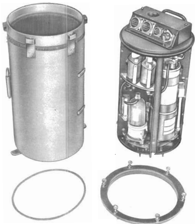
Bild 45. Modulatorens monterad ur behållaren, sedd från modulatorsidan.
