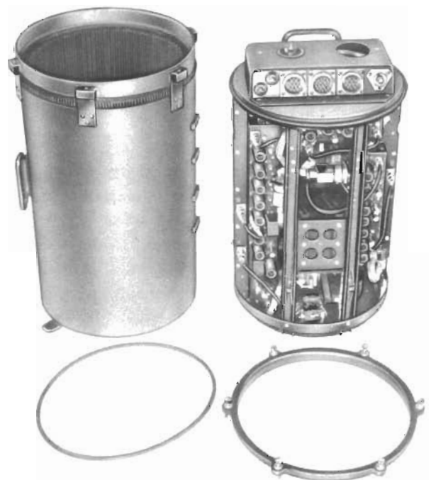
Bild 37. SM-enheten monterad ur behållaren, sedd från ena sidan.
