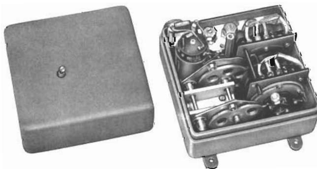
Bild 35. Programgivaren med avtagen kåpa.
