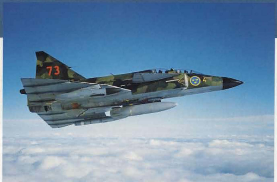
Viggens skolverversion SK 37 har modifierats för att kunna användas som störflygplan. De tillhör F 4 på Frösön.
