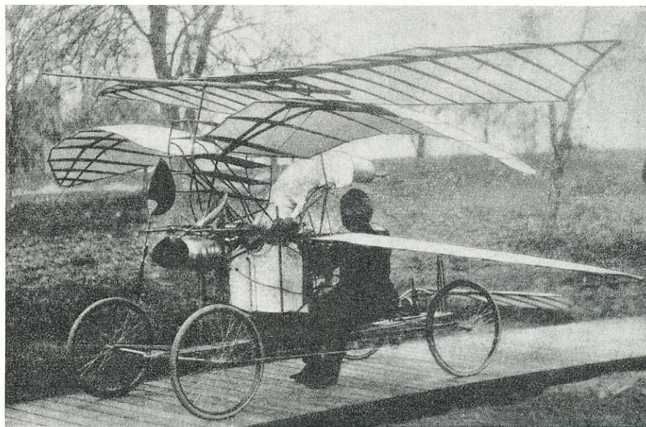
Nybergs ångmaskinsdrivna flygmaskin "Flugan" provflögs strax efter sekelskiftet. Den kunde lyfta men förmådde inte bära någon passagerare.
