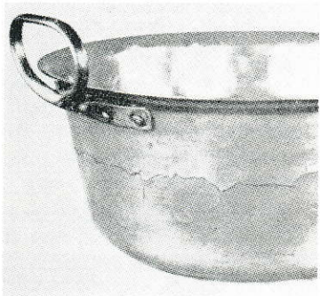
Dragen kittel, sprucken genom spänningskorrosion
