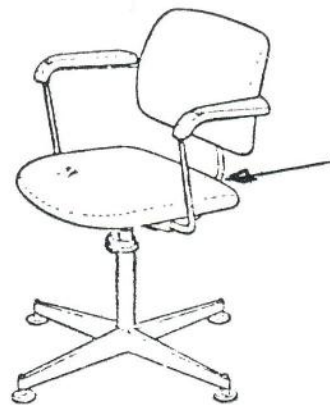
Vid pilen en enkel skruv som lossade.
