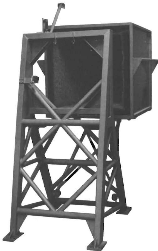
Bild 4:3. Antennstativ med dämpkammare.
