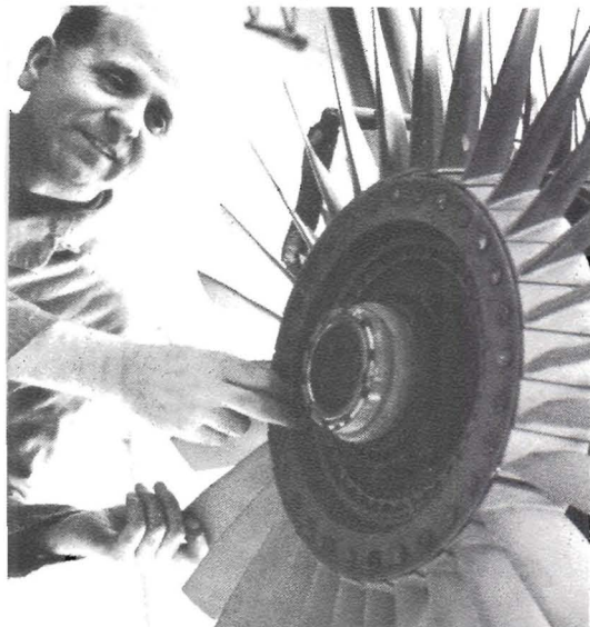
Kontroll av kompressorrotor.
