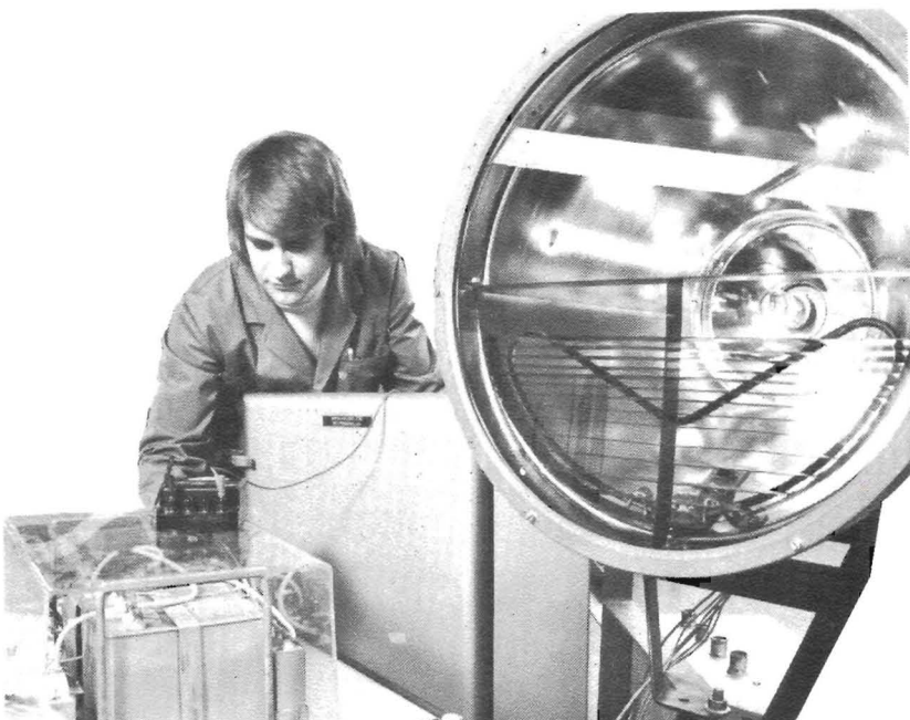
Underhåll av flygplatsbelysning.
