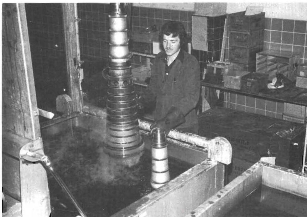
Vi handskas med över 1000 olika kemiska produkter inom U-sektorn. På bilden rengör Ulf Petersson kompressoraxlar.
