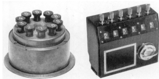
T. v. första svenska fingerskivan, Lars Magnus Ericssons »väljarskiva». T. h. ing. Löfgrens impulsgivare med tryckknappar och ing. Edlings konstruktion med avläsbar inställning.
