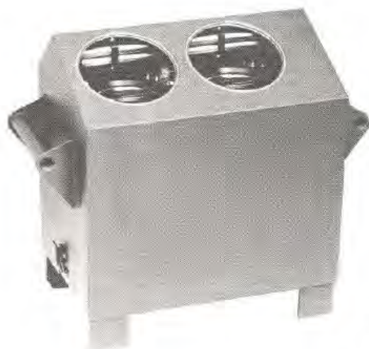
I den modernare observationsutrustningen ingick lasermolnhöjdmätaren BEAB CBME 40A MOBILI. Den anskaffades redan 1992 och försågs då med en bärbar PC som avläsningsenhet i väntan på MOMS.
