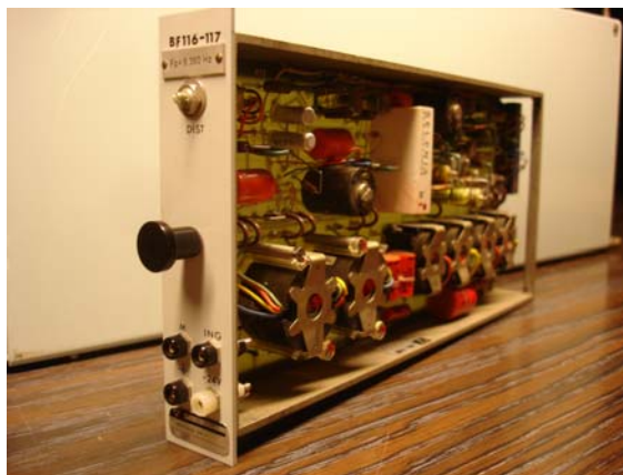
Figur 1: Exempel på TM-10 kortkassett. Ett FSK-modem DT106.
