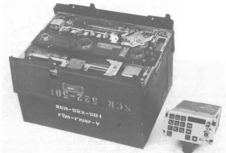
Den första VHF-stationen – Fr VII (SCR-522), tillsammans med den senast utvecklade flygplansradion – Fr 31.
