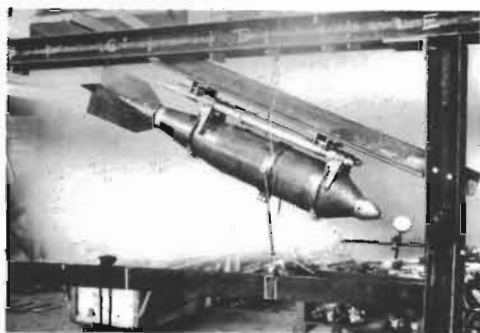
Provhängning av bomb i nykonstruerade ställ.
