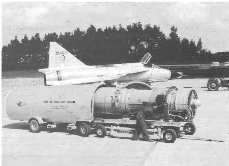
CVM – tillverkning görs av mobil motorbehållare avsedd för den väldiga Pratt & Whitney-motorn RM8.
