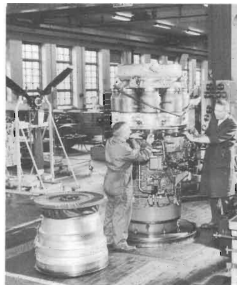
Motoravdelningen vid CVM - montering av motor RM5A/B.
