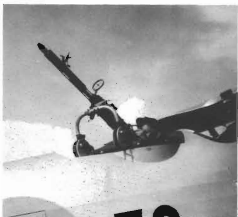
Kulspruta m/22 typ COLT med ringsikte och flöjelarm. Montage i flygplan B4 1937.
