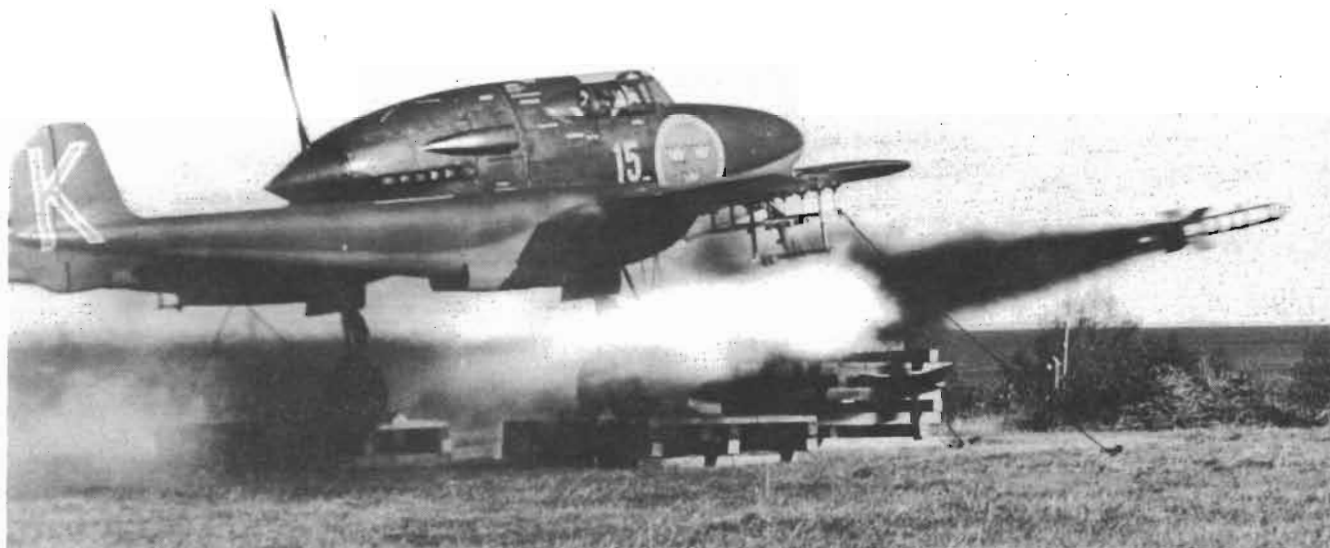
18 cm sprängraket provskjutes från en förankrad J21:a vid Försvarets försöksplats i Karlsborg (FFK).
