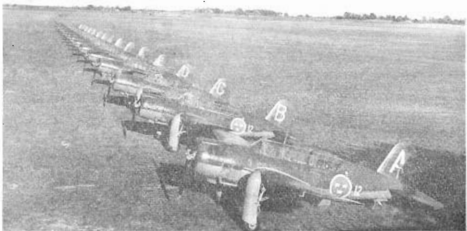
Flottiljens första krigsflygplantyp, B 17C, var ett tvåsitsigt lätt bombflygplan, helt svenskbyggt av SAAB.
