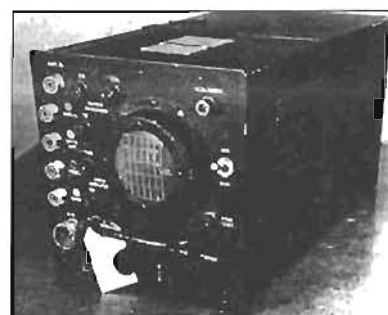
Indikator nav-och landningsradar Foto "Mosquitoboken".
