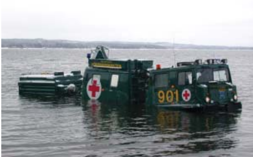
Jodå, den flyter. 2077A är helt tät och kan framdrivas i vatten. Det extra räddningsläpset innehåller bland annat 2x70 kilo brandsläckningspulver och spadar.
