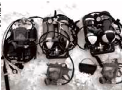
Tre lätta luftdykapparater (2x5 liter, 300 bar) har ingått i FMV:s prov. Från vänster: Poseidon med stålflaskor och Extremeregulator, Interspiro med stålflaskor och Mk II-regulator samt testvinnaren Interspiro med kompositflaskor och Mk II-regulator. Utan en extravikt på åtta kilo flyter kompositutrustningen.
