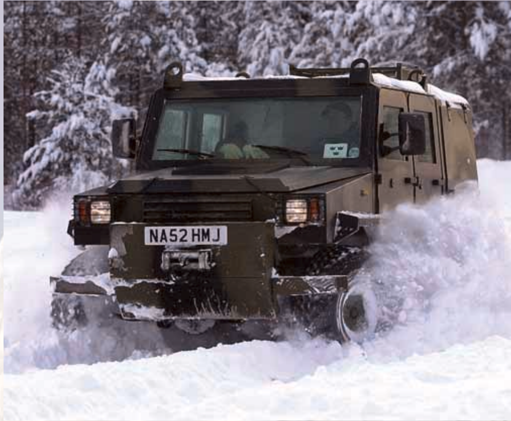
35 centimeters snödjup på ett fält i Arvidsjaur var inget problem för den sydafrikanska, Alvis-tillverkade terrängbilen RG32M.
