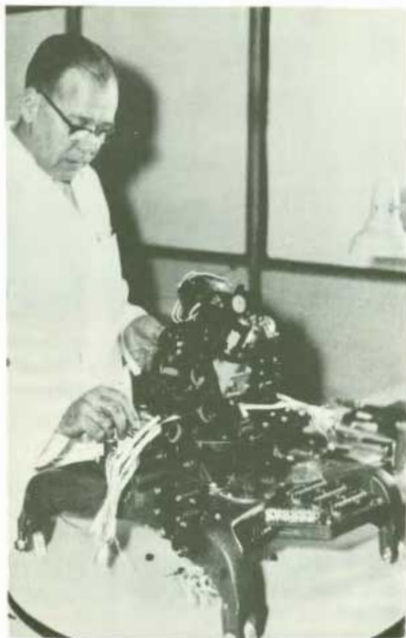
Montering av radarantenn
