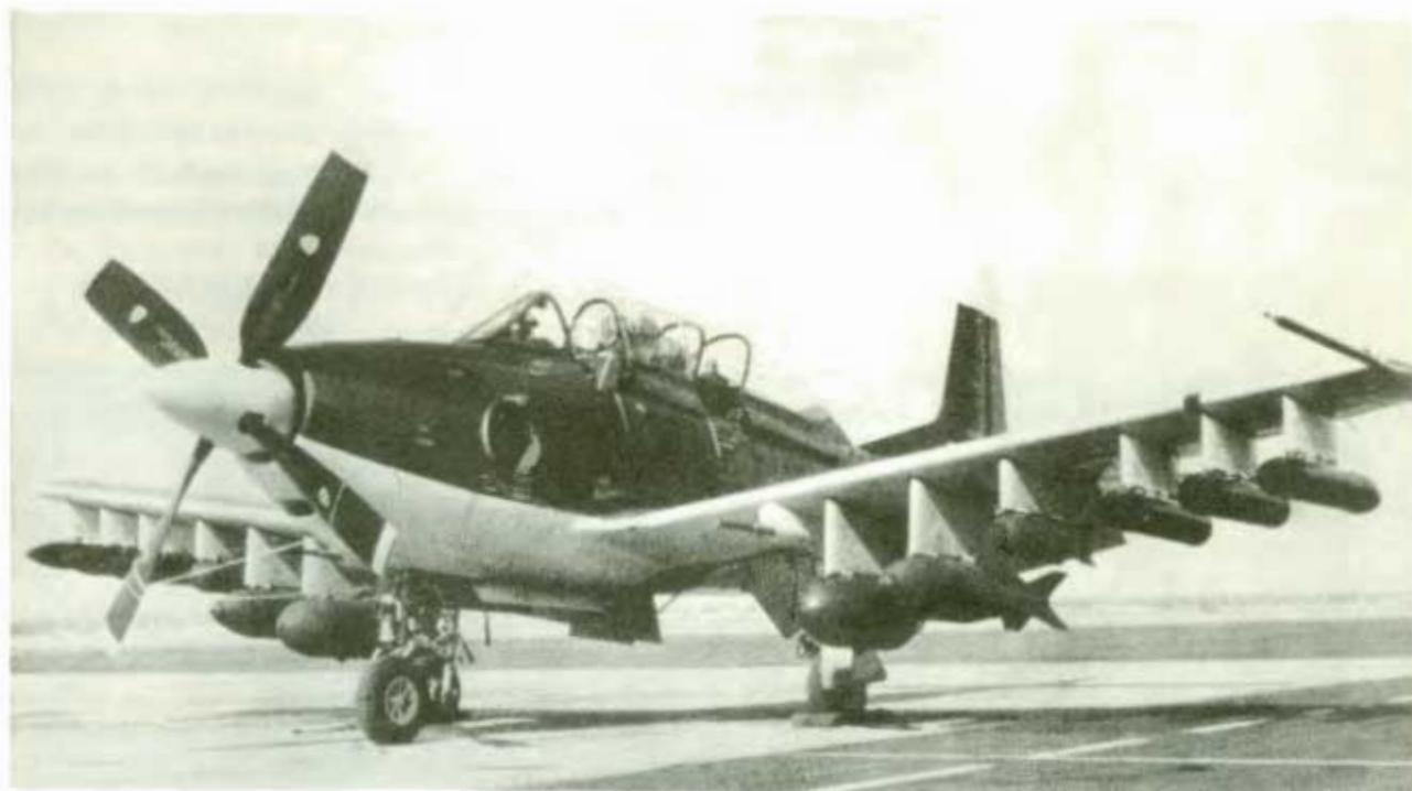
North American Aviation YAT-28 har en yttre beväpning på nära 2.000 kilo i form av bomber, raketkapslar och automatkanoner.
