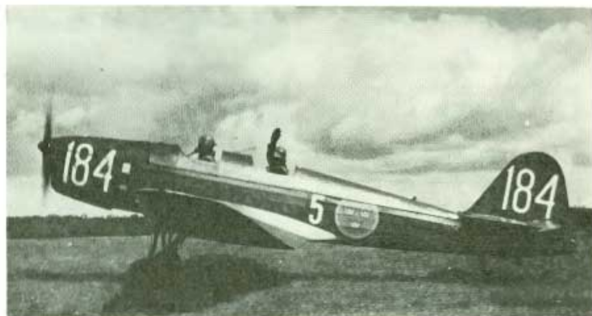
START TILL FLYGLEKTION på Ljungbyhed. Planet är ett skolflygplan "Sk 15" av typ Klemm 35 med 85 hkr Hirth-motor (HM 502). De första Klemm-planen hyrdes från civila svenska ägare. Andra skaffades — till stort antal — i början på 40-talet. Bilden tagen den 14 juli 1943. Foto: F. Hallström.
