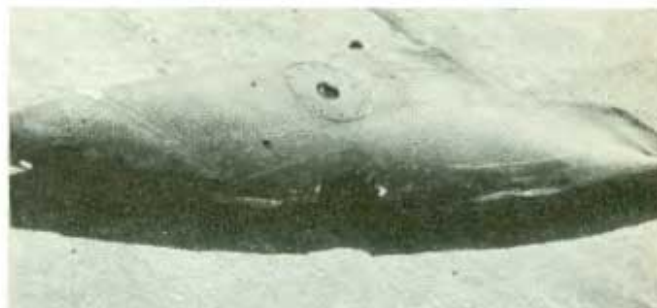
Kollision med markföremål är ingen ovanlig förekomst — tyvärr! Bilderna visar en kollision mellan en A 32 och en tankbil, uppställd för nära taxibanan, och den skada på vingspeteen som då uppstod. En onödig "malör"! Skärp därför uppsikten kring flygplanet vid in- och utkörning.
