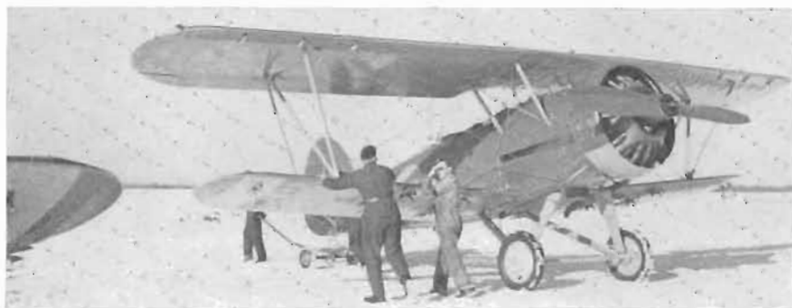
"Lätta bombplan" B 4 (attackplan) var september 1939 krigsflygplan på F 4, var då enda lätta bombflottilj. Toppfart ca 250 km/tim. Motor svenskbyggd 650 hkr Nohab My VII.
