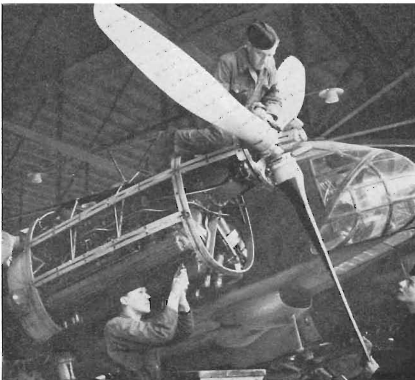
FRÅN ITALIEN år 1940 nödköpta Caproni Ca 313 (S 16 och B 16) blev trogna verkstadskunder. Här tillsyn på en av de två 725 hk Isotta-Fraschini Delta-motorerna på ett dylikt plan. Flygplanets toppfart ca 440 km/tim.
