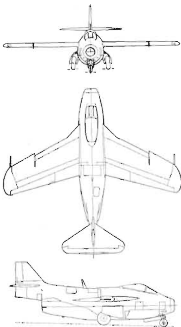
Treplansskiss av J 29 F. — Som synes finns det en del skillaktigheter jämfört med skissen överst på sidan.
