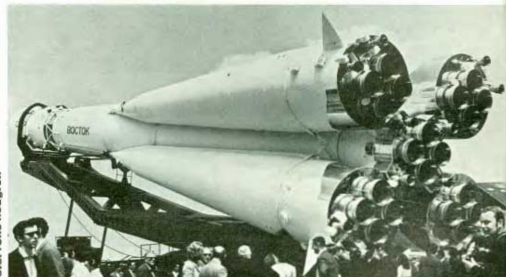
En dominerande syn på le Bourget var mastodonten Vostok. Den bemannade rymdälderns plonjär nr 1. Det måste otvivelaktigt ha känts något märkligt för Gagarin när han steg in i den 38 m långa, nästan 5 ton tunga raketten för att med hjälp av 20 milj hk låta skjuta ut sig i en oviss rymd...
