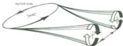
● Bilderna i v och nedan visar helikopters rotorbladsströmningar bildande ändvirlar med centrerad nedåtriktad verkan.
