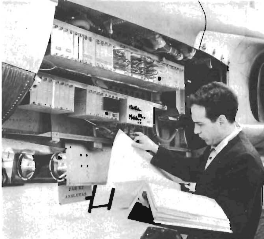
◆ Del av mätutrustning i ett tpl 32 A, där databandspelare, silingoscillograf och ett antal mätkameror — de senare pla- cerade i en kapsel under flygplanet — ingår som registrer- organ.
