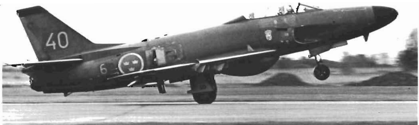
• En A 32 Lansen ur F6 demonstrerar här en perfekt AD-bromsning i landningen.
