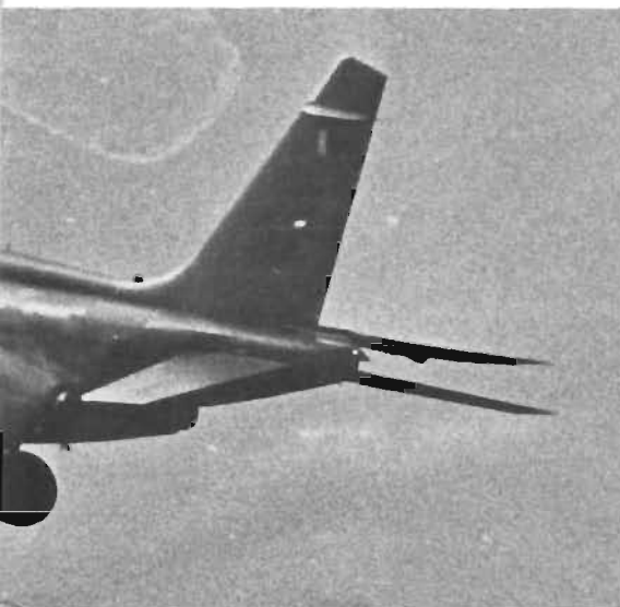
▲ 33 Alpha Jet i rent sk-utifrånande skall om några år tillföras FAB, ersättande Fouga Magister som jetsk-fpl 1. (Hittills har dock bara 4 Alpha-protyper flugit...) — Alpha Jets infällning av huvudställen är en sevärdhet. Hjulen dras upp, framåt, inåt under vridning — en komplicerad procedur, som bilden bra illustrerar. (Ösökt bläddrar red. 30 år tillbaka i minnesalbumet och får som snarlik jämförelse fram J 22-ans ingenjörstekniska underverk till huvudställen etc.) Även F.1 har ett krångligt huvudställe.
