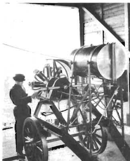
Ovan t v: Husarregementet övade på Bonarps hed. Stenen rest 1927. — Ovan t h: Prov med blivande (ASJA) SK 10. Lt B Jacobsson inför första svenska vägbasstarten, 6/8-30. — Nedan: Körning av stjärnmotor i provbänk, 1930.
