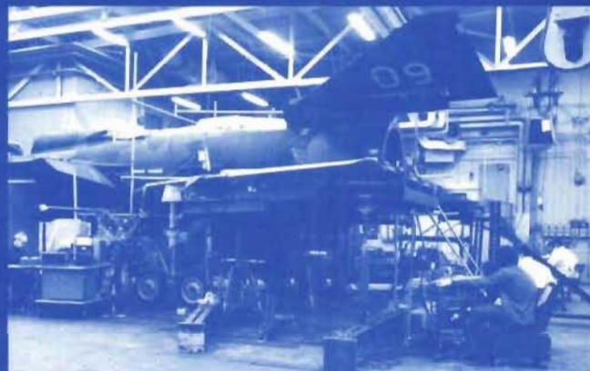
Laster och påkänningar i ving- och kroppsstruktur kartläggs bl a med hjälp av trådtöjningsgivare. Luftlasterna simuleras med hjälp av hydrauliska domkrafter.
