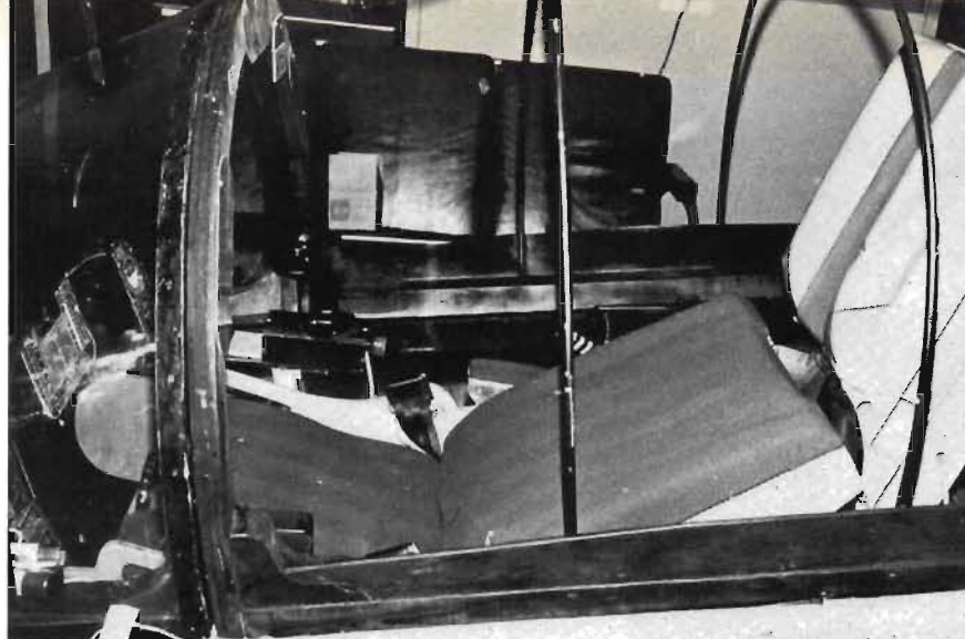
● Interiör av HAC-mock-up (High Acceleration Cock-pit). Stolen kan lutas 60° bakåt, vilket möjliggör belastning upp till 10 g.
