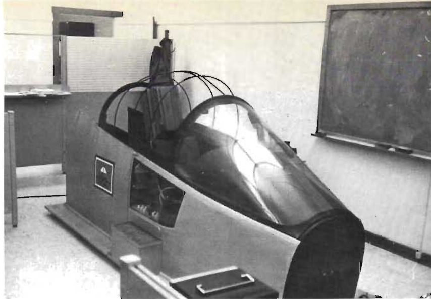
● Mock-up av High Acceleration cock-pit (HAC).
