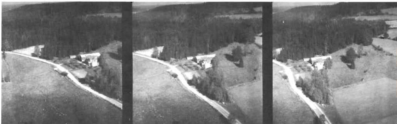
▲ Dessa bilder är tagna på 100 m höjd och vinkelrätt mot flygriktningen. Vid en fart på 900 km/h (250 m/sek) kan kameran "knäppa" en bild på var 30:de m. Bilderna kan dessutom direkt stereobetraktas. Prova själv. Sätt en kartongskiva el dyl mellan två av bilderna, parallellställ ögonen genom att låsta blicken på något föremål långt borta, tör ner blicken mot bilderna så att resp öga betraktar sin bild (höger–höger och vänster–vänster).
