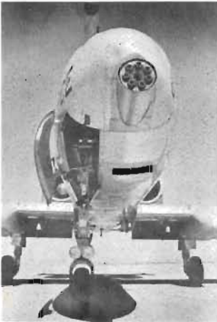
Th och ovan: Automatkanonen på USAF:s A-10A. Den enorma pjäsen är placerad med den 7-pipiga mynningen i nosen och resten i mitten av underkroppen, vilket bl a medfört att noshjulet förskjutits till högersidan. Ett mått på kanonens storlek erhålls vid jämförelse med t ex en Volkswagen-bil. – Nedan: Två exempel på närunderstödsuppdrag för A-10:an. Prestandan imponerar.
