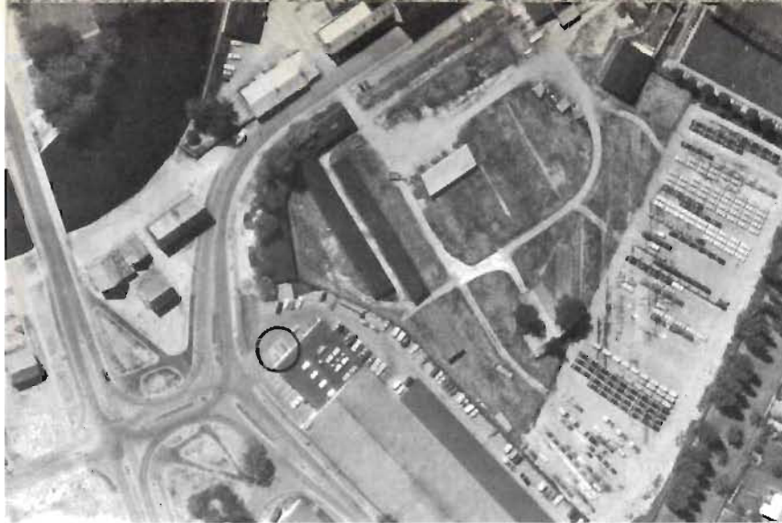
▲ De två inringade bilarna smälter ihop med underlaget (asfalt), vilket gör dem svårare att upptäcka. De ljusare och mörkare bilarna däremot är väl synliga. Bilden har stor skala (1:2600), vilket bidrar till att de inringade bilarna lättare upptäcks.
