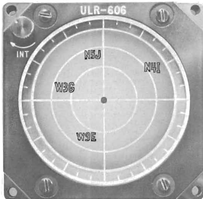
Fig 6: Modern radarvarnare visar information på ett litet instrument (scope) — förutom riktning även pulslängd (N eller W), pulsrepetitionsfrekvens (0–9) och våglängd (E, G, I eller J).
