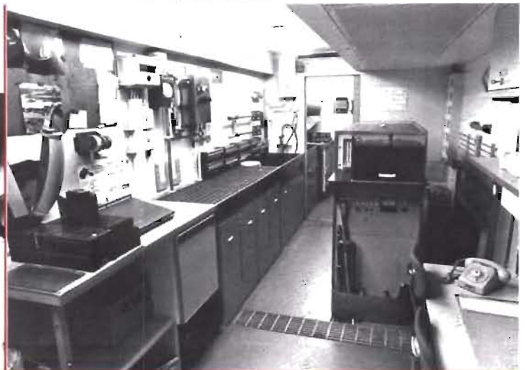
● Framkallningsrummet för flygfilm. All framkallning sker i dagsljus. Längst bort syns utrymmet för kopiereställning.
