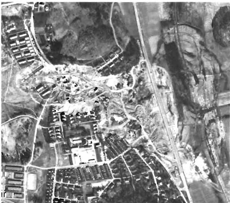
Exempel på högfoto från S 37. Bilden är som en mycket exakt och detaljrik karta. Mätningar kan utföras med stor noggrannhet. Denna bild föreställer området för TUVE-raset (30/11 1977) utanför Göteborg. Bilden tagen fem månader efter katastrofen.
