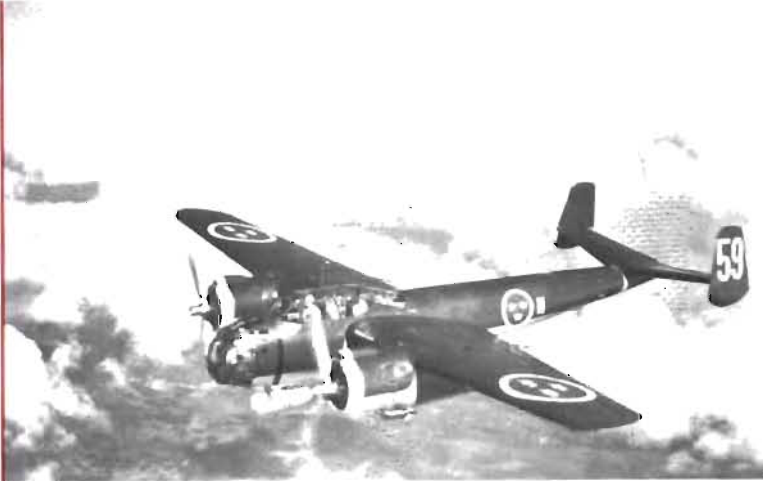
SAAB S 18A avlöste trotjänaren B 3 som fjärrspaningsflygplan. Det blev vårt första radarutrustade spaningsflygplan. Radarn gav en helt ny dimension åt havsövervakningsuppgiften, som nu kunde ske även under mörker och i dålig sikt — samt dessutom med färre flygplanföretag än tidigare.
