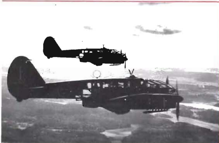
● S 16 Caproni Ca 113 inköptes från Japan 1941. Svartan och andra förändringar tillkom på försvarspaningsplan. Andra ändringar: maskinmotor 40, skjututrustning 84, rödskuggor flyghöjden 24, hastighet 240 km/h. Motorerna var av typen 11, och hade utökat spaningsutrustning. 41 besättningsmän, varav 3 flygförare utvalda 1945-46. Caproni-affären gjorde för all framtid framstå som ett varnande
