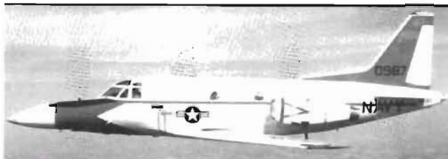
Ovan: US Navy nyttjar en 'Sabreliner' för prov med radar + avionik till F-18 'Hornet' – Navy:s och Marine Corps nya jakt-fpl.
