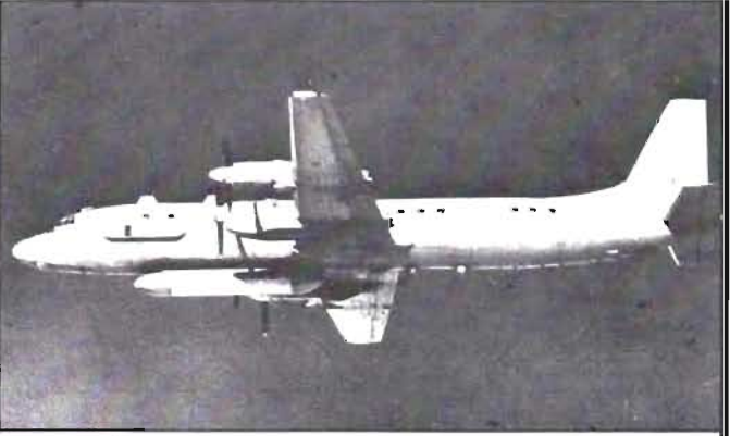
Ovan: Sovjetiska förband opererar från Polen. Il-18D 'Coot A' är ett signalspaningsflygplan utrustat med SLAR (= Side-Looking Airborne Radar).
