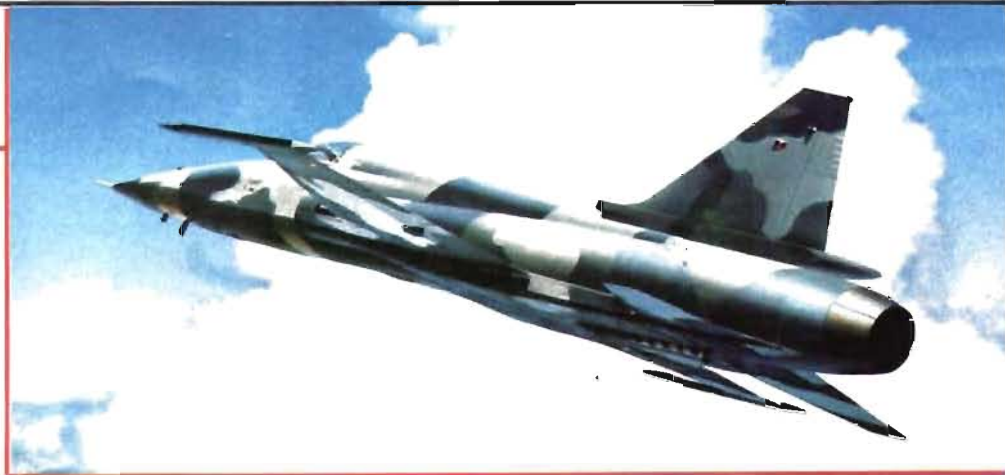
Bild F: Tekniskt utseende av flygplanet JAS 39 som beräknas flygtestas i slutet av 1992. Åssets förses med F404-motor och ett CCW-system kallat CCS.
