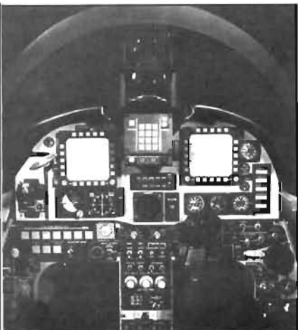
Förarens instrumentbräda domineras av två instrument som presenterar radar- och vapeninformation.
