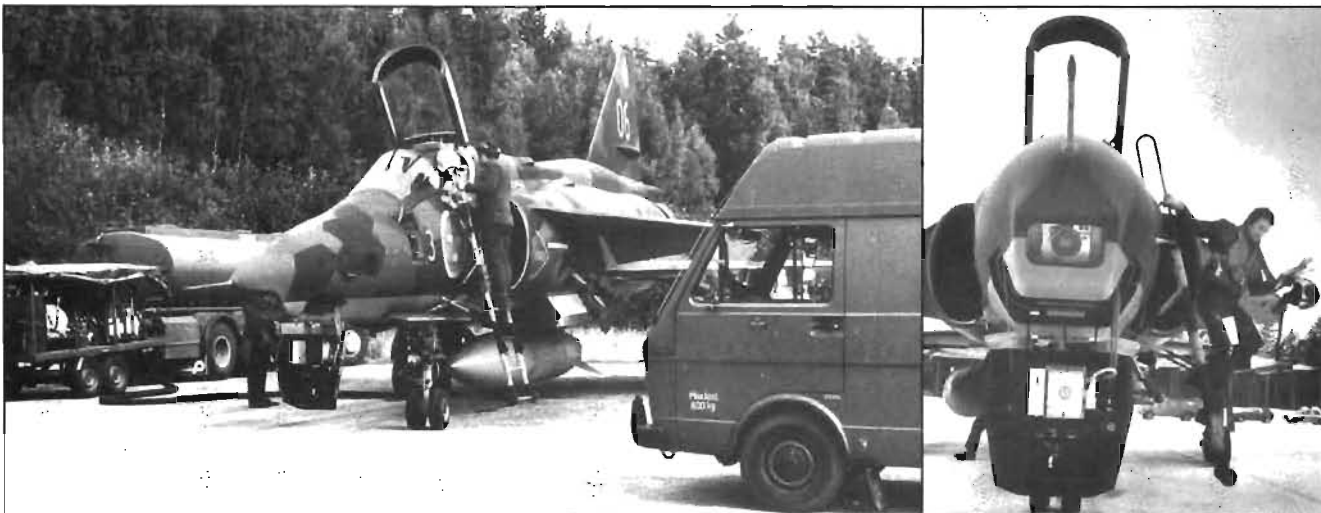
Bild 1: En SF 37 SpaningsViggen har just landat efter ett fotospaningsuppdrag. Föraren hoppar ur, kamerans kassetter demonteras, mörkrumsbilen med utrustning för plundring och omladdning har kört fram.
