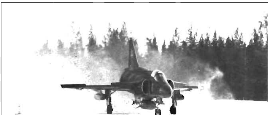
Utländska gäster imponerades av vlnngen av Bas 90-systemet. Speciellt av starter + landningar på glashala banor (bromskoefficient ca 0,1).
