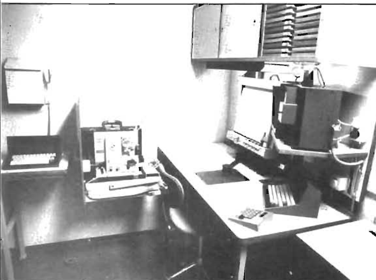
Bild 6: Radarbordets analysprojektor kan enkelt svängas fram för att underlätta laddning med film. Över bordet finns skåp med blanketter och kartor.
