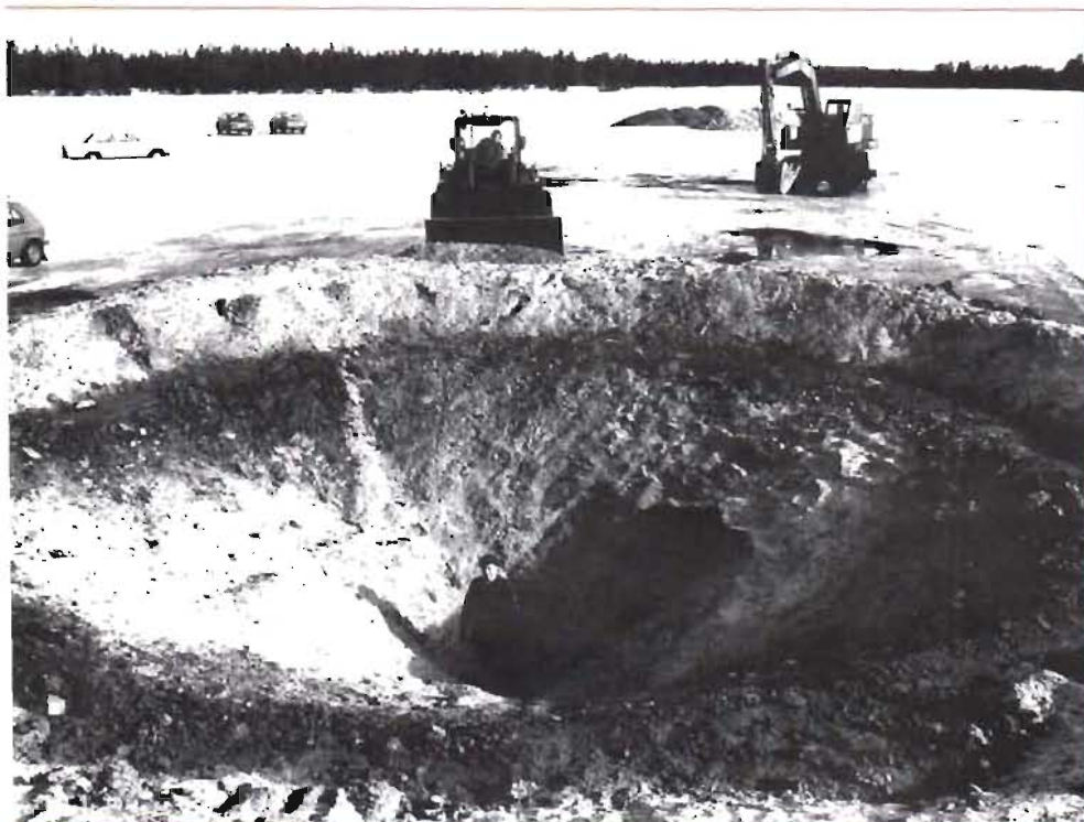
Efter detonation av 1 kg en 250 kg minörbombs uppstår en krater på basarealerna som är ca 4 m djup och 10 m i diameter
