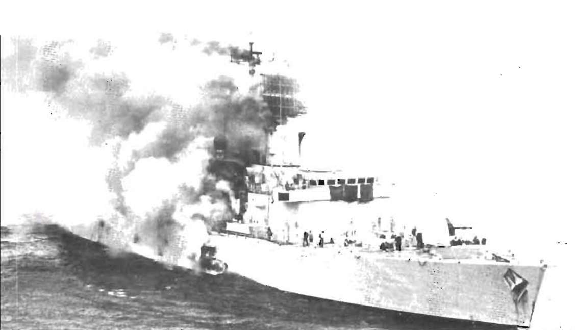
Ovan: Förvisso träffades jagaren "Sheffield" av en Exocet-rb. Förvisso sjönk hon senare. MEN rb briserade sannolikt INTE. Det var rb:s bränslerester som antände "S". Elden spred sig via plastisoleringen (pga för lå säkra lartygsskott; ett lackligt bekvämlighetskrav) till ett lager matolja ... som orsakade totalbrand. – Dyrköpta erfarenheter.
