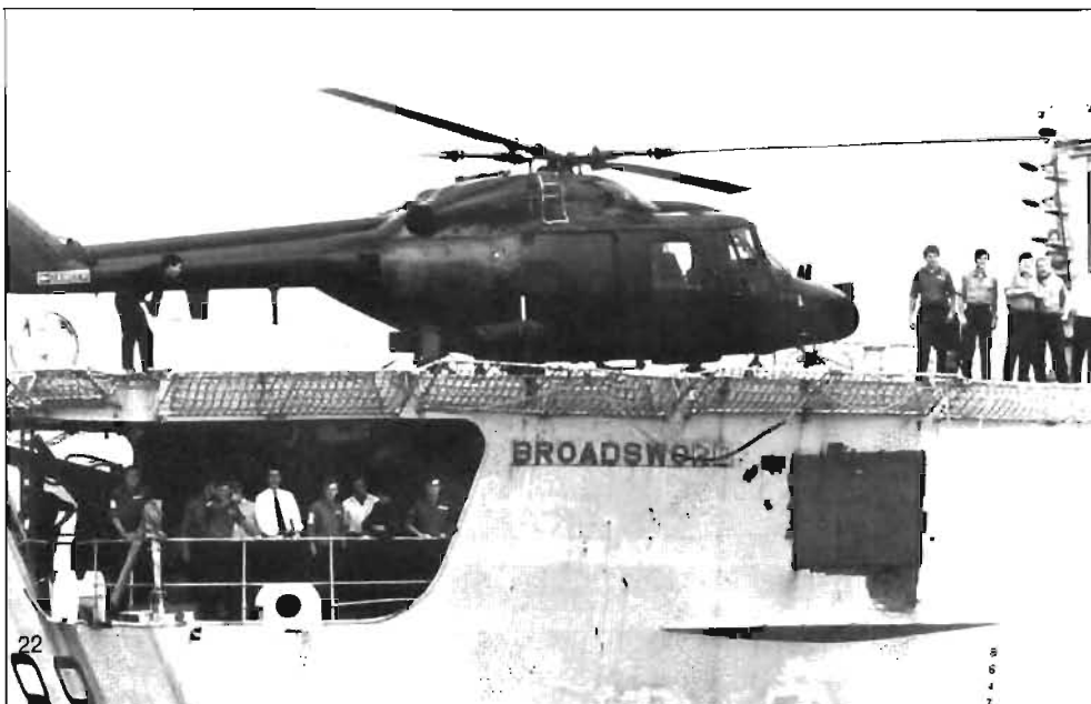
Fregatten "Broadsword" med en lyrkantilg plåt sveltad över hålet efter en argentinisk "dum järnbomb", som studsade genom fartyget utan att brisera.
