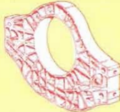
Vingkoppelspantet, som är den mest komplexa enheten i skrovet, kräver mycket bearbetning i femaxlig NC-maskin.
