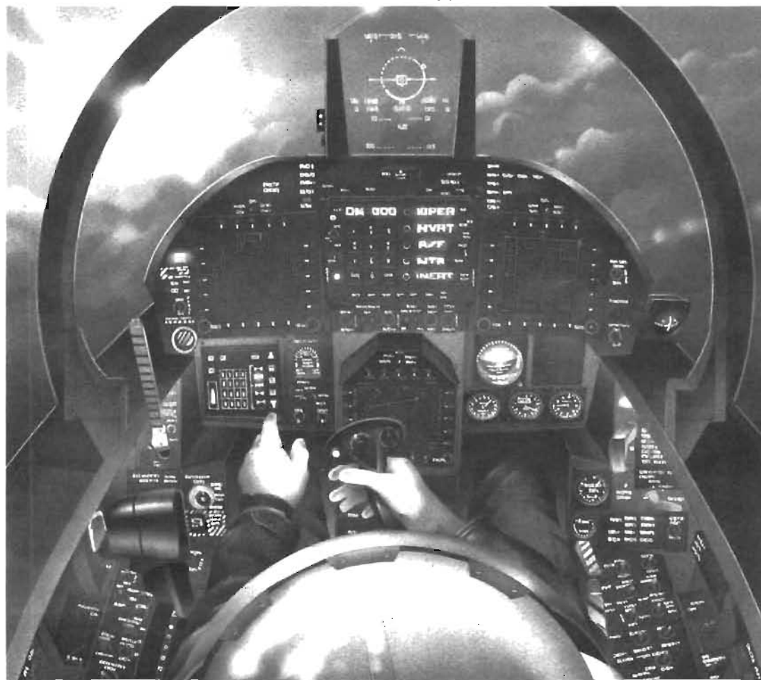
Bildröret nere i v (som handen pekar på) är en fullfärgs pekskärm. I det här läget har föraren kommenderat upp vapentablån. Han arbetar sedan direkt på bildskärmen. Samma teknik används också i den datorstödda undervisningen.
