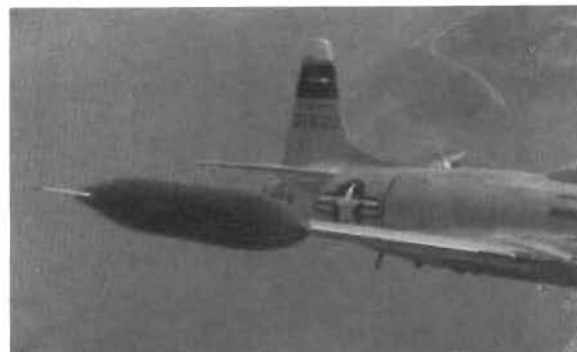
Bild 4: I denna amerikanska T-33 provflögs ministryspaken ett 30-tal pass 1983. Flygplanet är ett flygande laboratorium som med datorers hjälp kan ges olika egenskaper, bl a variabel stabilitet. Vid proven, som flögs av Tord Grims och Gösta Sjöström (Saab-Scania) och Järd Gisselman (FMV-PROV) jämte Calspans provflygare, simulerades vissa av JAS 39 Gripen's flygegenskaper med T-33.
