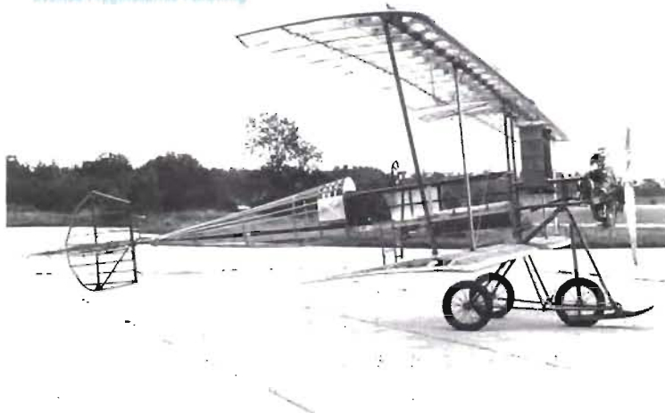
Streguet B 18, det första av staten anskaffade militärflygplanet. 1912 provmonterad utanför en hangar på Barkaby (gamla FK) i augusti 1985. Motor kylare och stjärtarm är originaldelar (svigt nyttillverkat Fiat-tank oljetank och framme sitter armén av monterade). Fullskalemodell byggd av medlemmar i Svenska Flyghistoriska Förening.
